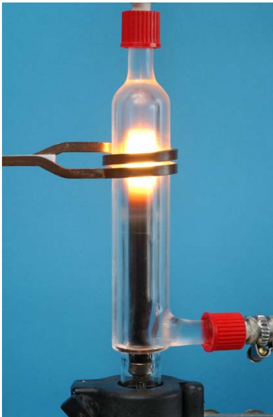
Hochtemperaturzelle (HTZ) mit eingekoppelter Generatorleistung von 40 % entsprechend einer Temperatur von ca. 1260°C
