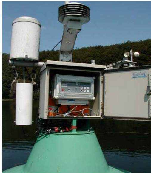
„Klimastation Holzmaar“ mit Datenaufzeichnungsgerät (Data-Logger); installiert auf einer Boje nahe der Seemitte
