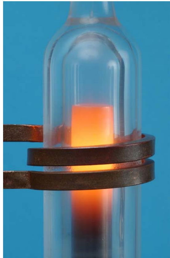
Detailansicht der Hochtemperaturzelle (HTZ) mit eingekoppelter Generatorleistung von 30 % entsprechend einer Temperatur von ca. 1000°C
