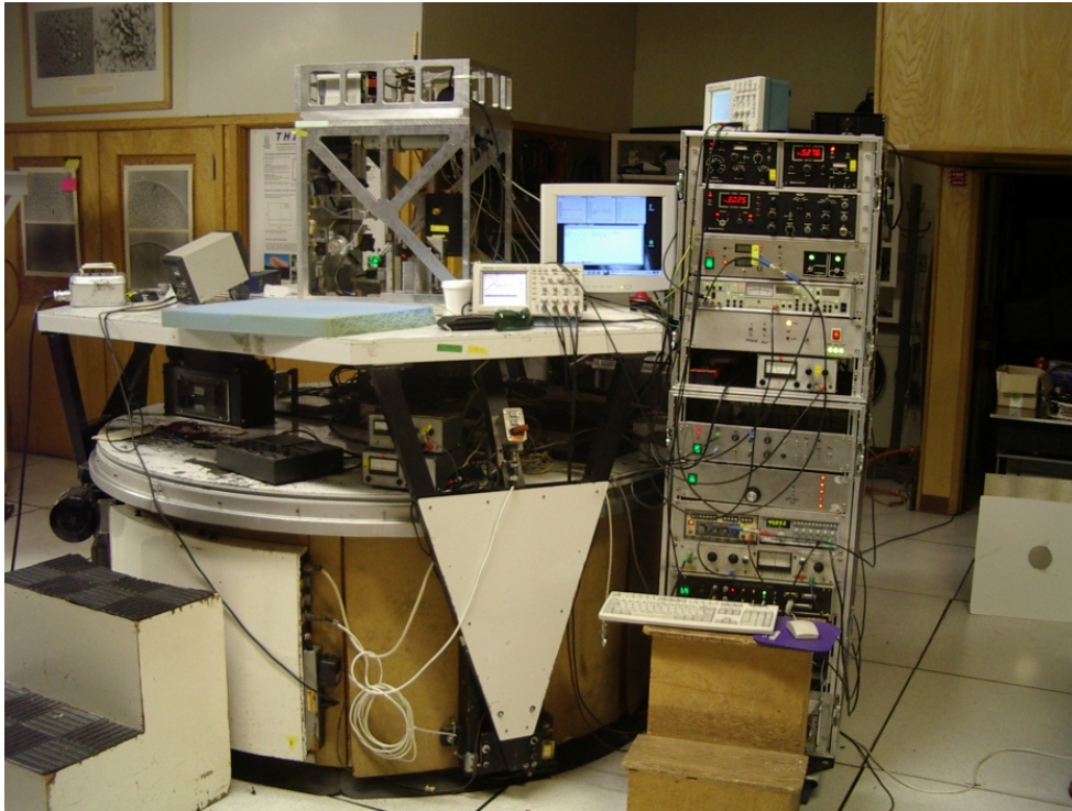
Abbildung 1.1: Das IR-Heterodyn Instrument THIS auf der Beobachtungsplattform des 1.5 m McMath-Pierce Sonnenteleskops des National Solar Observatory am Kitt Peak nahe Tucson/Arizona.
