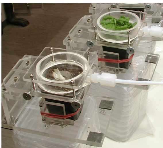
Abb. 2.9: Messküvette für die Bestimmung der Isoprenemission einer A. thaliana -Pflanze.
