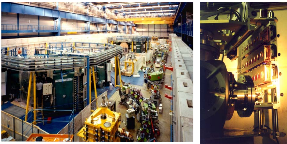
Abb. 2-7: Blick auf das Zyklotron CSS des Schwerionenbeschleunigers GANIL (links) und Bestrahlungseinrichtung für Zellkulturproben mit Proben im Strahlfenster (rechts).
