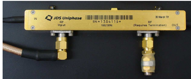
Abbildung 3.28: Phasenmodulator, links ist der Anschluss für das RF-Signal und rechts ein Abschlusswiderstand zu sehen.
