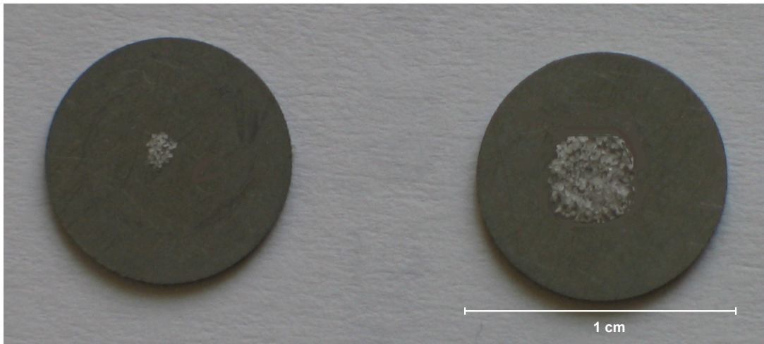
Abb. 6.1.1 Aufnahme zweier Probenräger. Links ist ein 1 mm-Aliquot, das mit etwa 50-100 Körnern belegt ist und rechts ein 2 mm-Aliquot, belegt mit etwa 400 Körnern, dargestellt.
