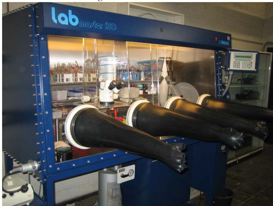
Abbildung 10-1: Vier-Arm Handschuhbox mit eingebautem Mikroskop.
