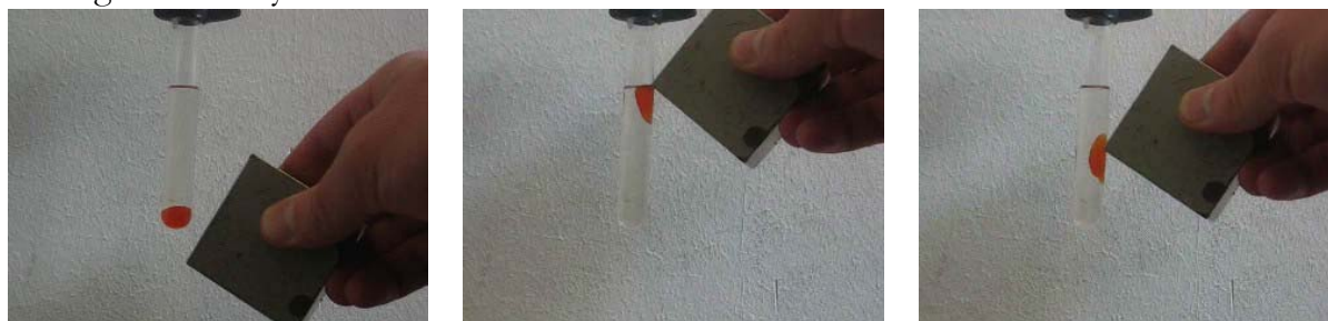
Abbildung 8-1: Reaktion der dysprosiumhaltigen ionischen Flüssigkeit auf einen Neodym-Magneten.
