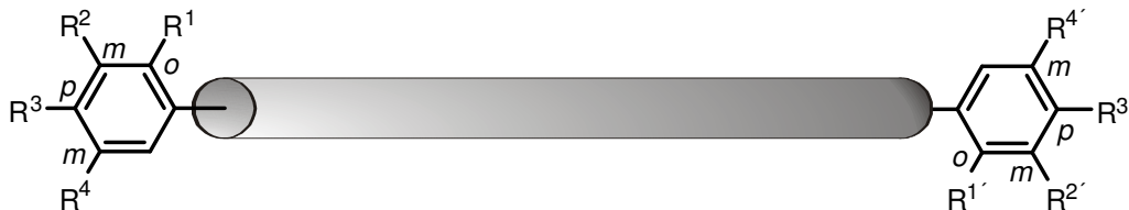
Abbildung 6: Genereller Aufbau polycatenarer Mesogene. Ein calamitisches Mittelteil ist mit drei bis sechs aliphatischen Ketten substituiert. Notationsformen wie 3mpm-3mpm geben die Anzahl der Ketten auf jeder Seite sowie deren Substitutionsmuster an.
