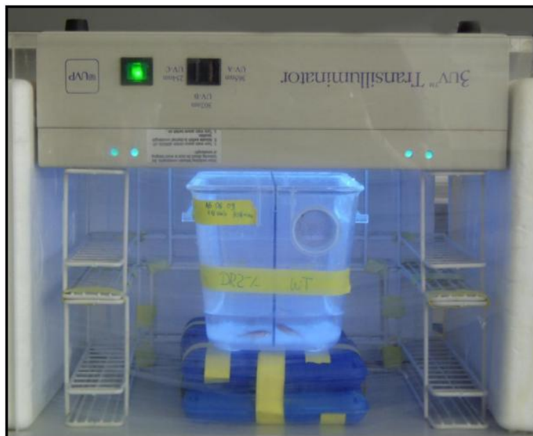
Abb. 9: Experimenteller Aufbau zur Induktion von UV-Stress
