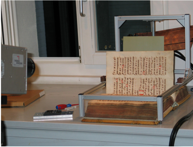
Abbildung 6. Aufbau zur thermographischen Aufnahme von Wasserzeichen in einzelnen Seiten aus einem historischen Buch 6 .
