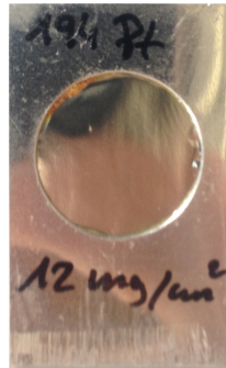
Abbildung A.3: Exemplarisch eines von drei ^{194}\text{Pt} -Targets, welches bei beiden Experimenten benutzt wurde.
