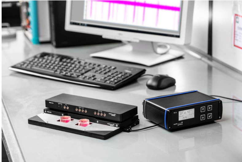
Abbildung 26: MEA2100-System: MEA Headstage in geschlossener Konfiguration mit zwei MEA Chips und angeschlossenem Temperatur-Kontroller. Im Hintergrund sind auf dem Monitor die Aktionspotentiale zu erkennen. Foto Credits: DLR, Fotomedien Köln
