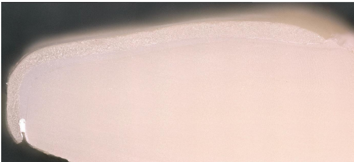
Abb. 8 Spaltbreite zwischen Veneer und Stumpf nach manueller Befestigung
