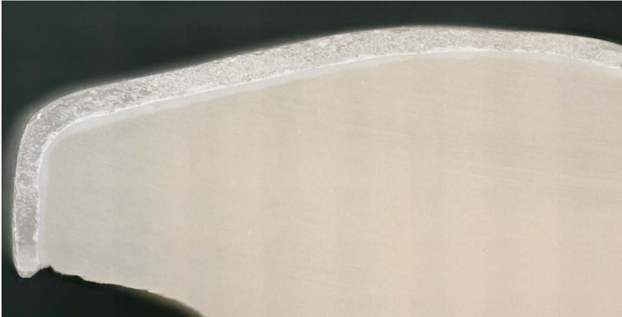
Abb. 9 Spaltbreite zwischen Veneer und Stumpf mit Befestigungshilfe
