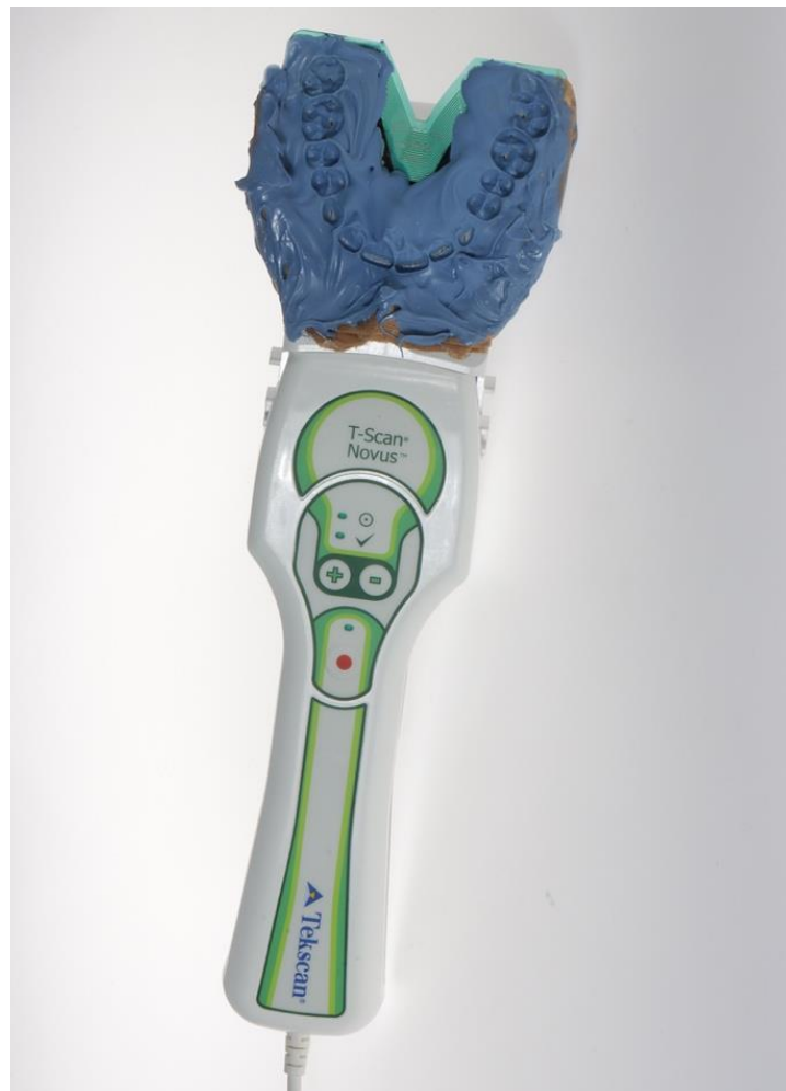
Abb. 2 Piezoelektrischer Foliensensor Tekscan™ mit individualisierter Oberfläche, eingespannt im Sensorhalter des Handles.
