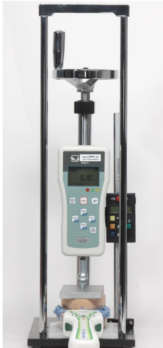
Abb. 6 Kraftspindelgerät mit platzierten Gipsmodellen zur Kalibrierung der Messungen.
