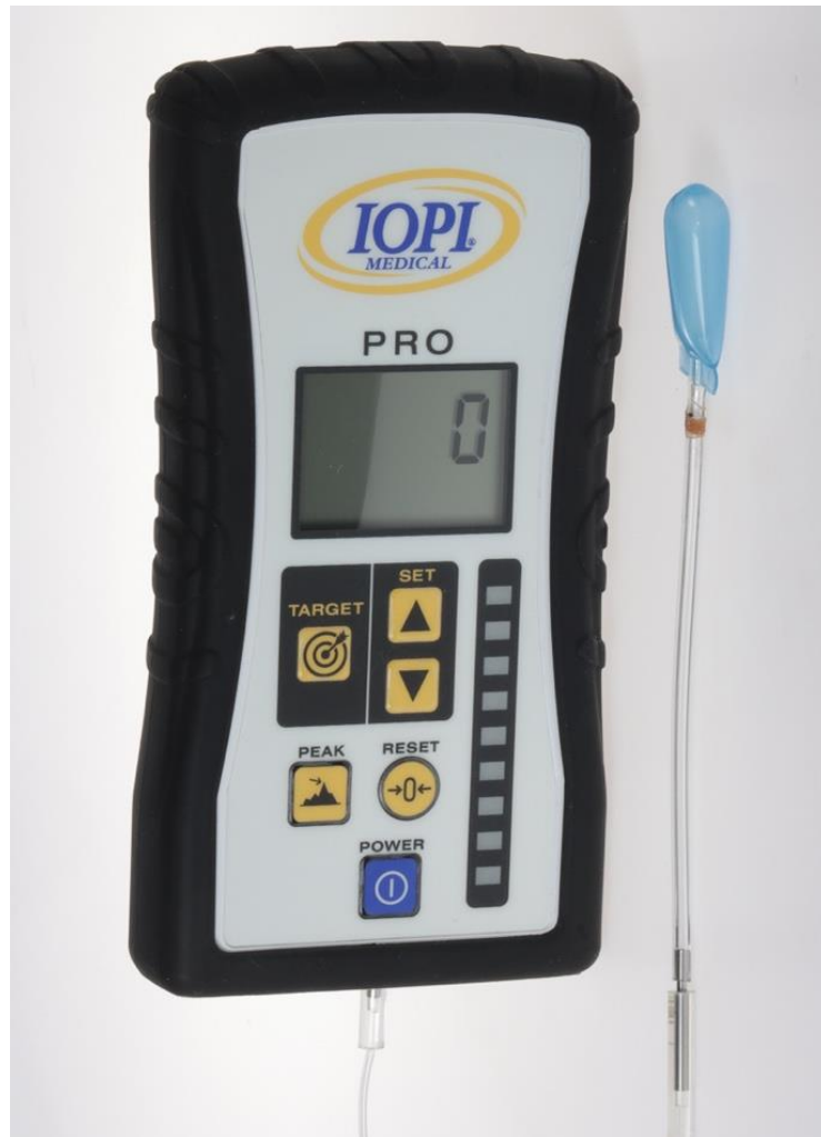
Abb. 8 Das logopädische Trainingsgerät IOPI® zur Messung der maximalen Zungenkraft und -ausdauer mit angeschlossener Zungenblase, die eine Markierung für die obere Schneidezähne aufweist.
