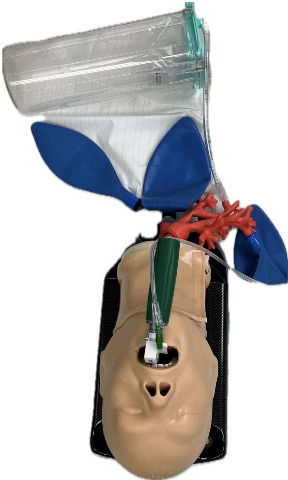
Abb 5. Versuchsaufbau: Intubationspumpe und Testlunge mit 3 L Volumen. Im Foto ist die Platzierung des Oxygenierungsspatels dargestellt.
