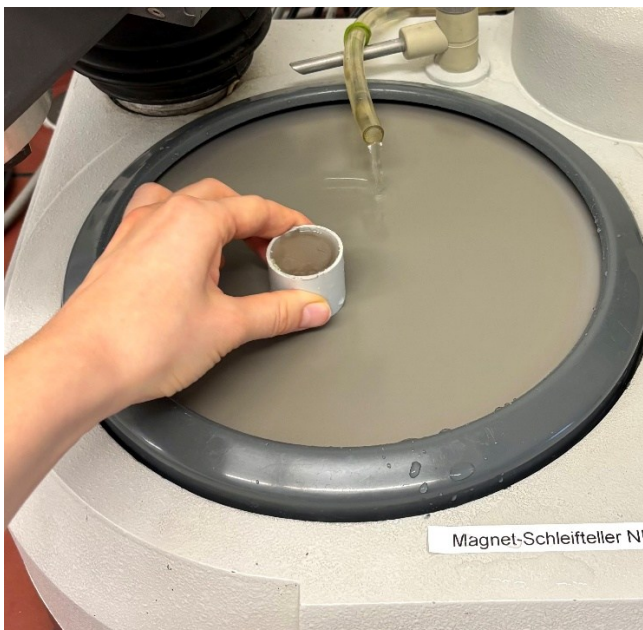
Abbildung 16 - Politur der in Kunststoff eingebetteten Querschnitte der Prüfkörper
