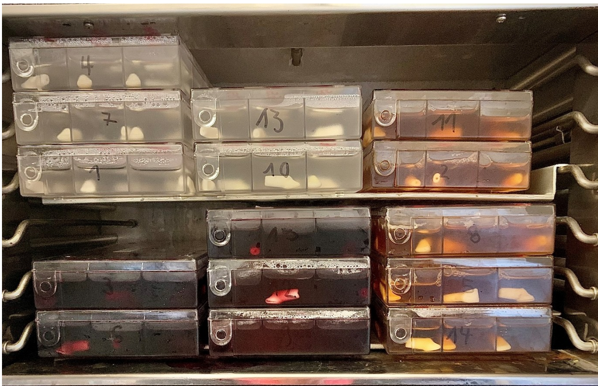
Abbildung 10 - Künstliche Langzeitalterung der Prüfkörper im Brutschrank bei 37 °C
