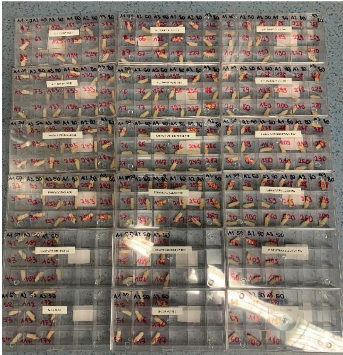
Abbildung 9 - Sortierung der 270 Prüfkörper in Kästen nach Befestigungskomposit, Lagerungsmedium, Stumpffarbe und Größe der Befestigungsfuge
