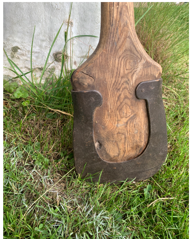
Abb. 27 Rekonstruktion eines römischen Spatens mit abgerundetem Spatenbesatz aus Eisen, anhand eines Fundes aus der Villa Fishbourne (UK).
