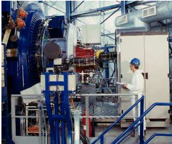
Abbildung 2.8: Die Fotografie rechts zeigt CONICA (rot) und NAOS (hellblau) am Nasmyth-Adapter (dunkelblau) des VLT Teleskops Nummer 4 während der Inbetriebnahme des Instruments im November 2001 (Bild: ESO).
