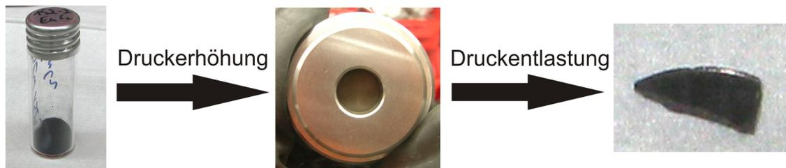
*Abbildung 3.1.9-1: Optische Veränderung der  $\text{EuC}_2$ -Probe unter Druck und späterer Entspannung.*
