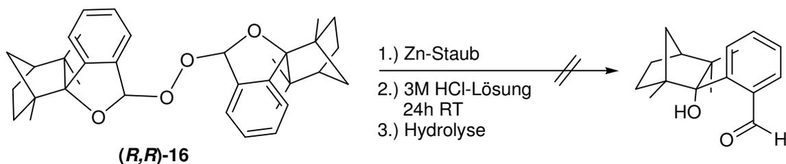
**Abbildung 62:** Versuchte Spaltung von 2,2-Bisbenzylfenchylperoxid **(R,R)-16** mit Zinkstaub unter sauren Bedingungen.
