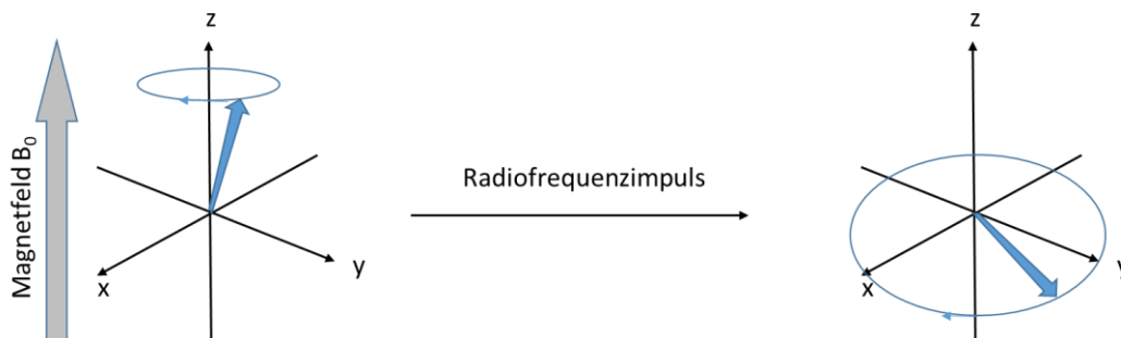
Abbildung 15: Darstellung der Präzessionsbewegung der Magnetisierung im Magnetfeld B_0 um die z-Achse (links). Drehung der Magnetisierung durch einen Radiofrequenzimpuls in die xy-Ebene (rechts).
