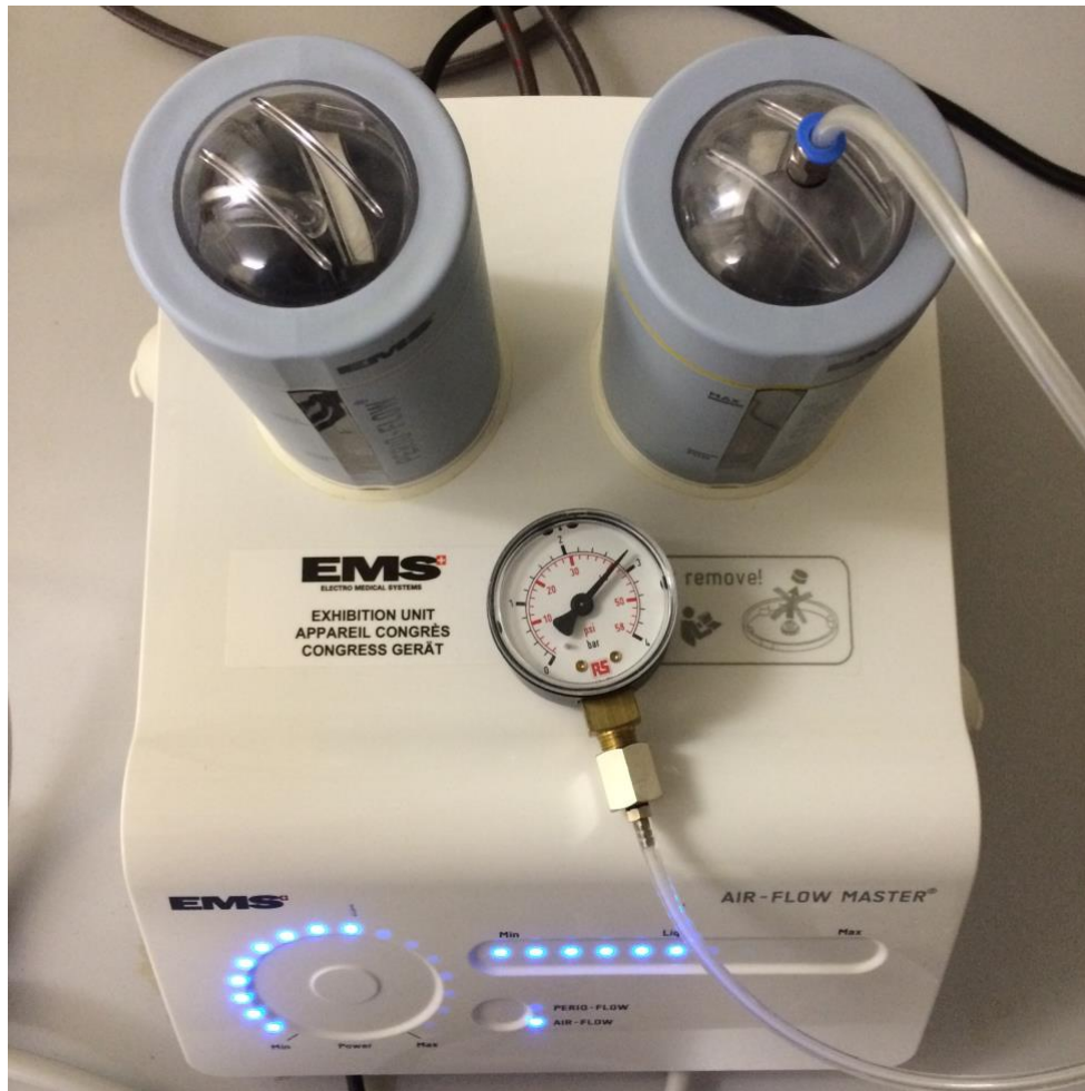
Abbildung 6: EMS Master® Pulver-Wasser-Strahlgerät mit angeschlossenem Barometer im Versuchsaufbau (eigene Darstellung)
