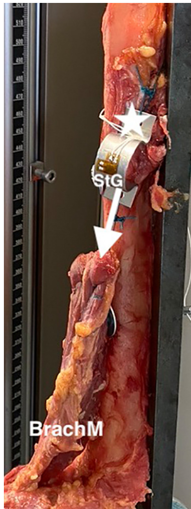
Abbildung 9: Humerusschaft eingespannt in Testvorrichtung; der Musculus brachialis (BrachM) wurde am proximalen Ende abgetrennt und mit dem Omega (weißer Stern) auf welchem sich der Dehnungsmessstreifen (StG) befindet, transossär am Ursprung des M. brachialis verbunden (Ott, 2021, https://doi.org/10.1016/j.clinbiomech.2021.105478 )
