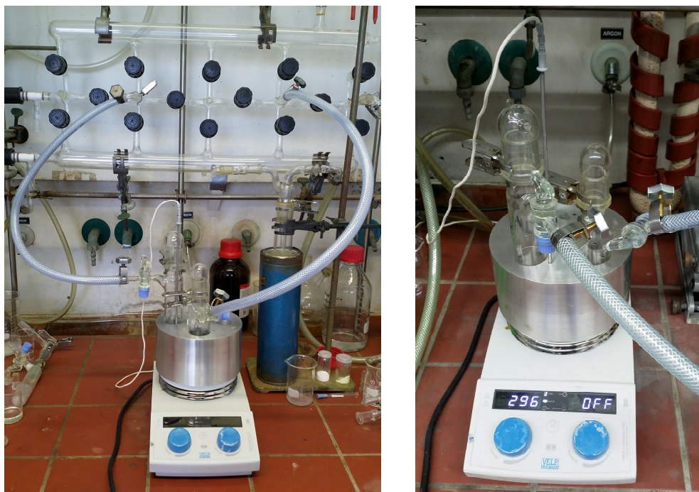
Abbildung 5.2: Fotografien des Versuchsaufbaus zur Darstellung der Systeme A_xA'_{2-x}PdC_2 ( A/A' = Na-Cs , A \neq A' ). Zu sehen sind die in Schlenk -Rohren unter Schutzgasatmosphäre gelagerten Proben, welche an die Vakuum-Argon-Linie angeschlossen sind. Die Proben werden mittels eines in den Werkstätten der chemischen Institute eigens angefertigten Aluminium-Heizblocks temperiert (eigene Fotografien).
