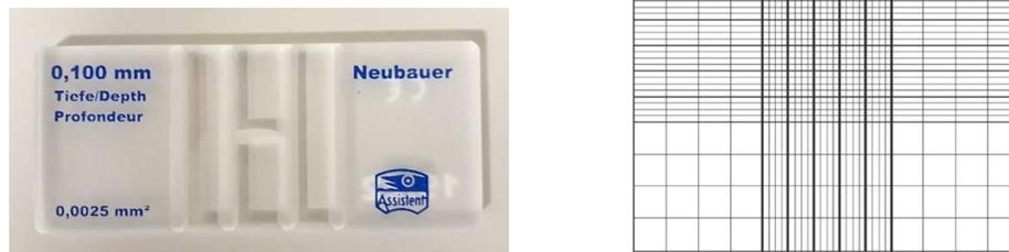
**Abbildung 3.1:** Neubauer- Zählkammer ohne aufgelegtes Deckglas (links) und Quadrantenmuster einer Neubauer- Zählkammer (rechts)
