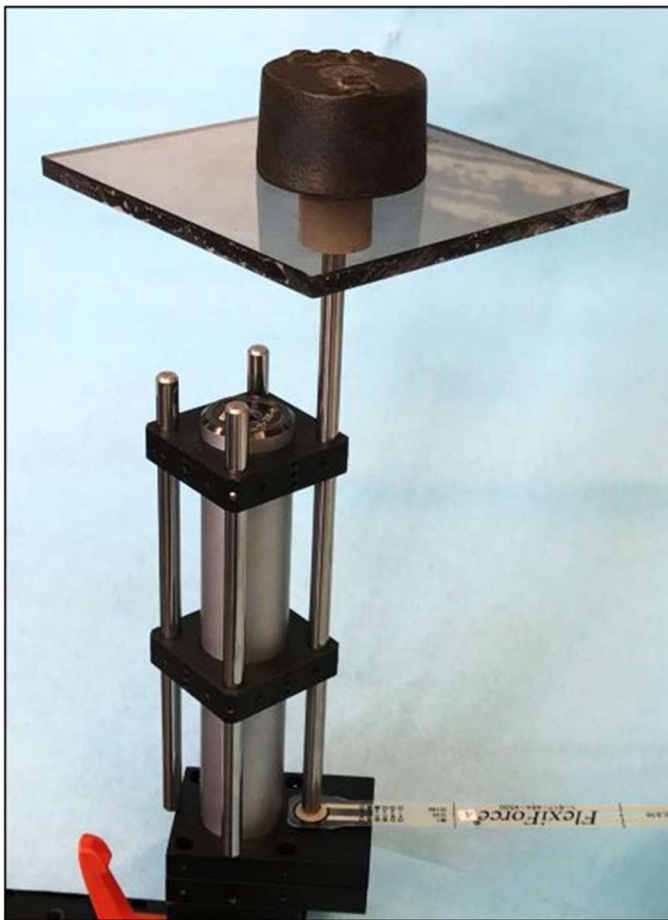
Abb. 8.1: Messvorrichtung zur Überprüfung des Sensormessverhaltens bei verschiedenen Belastungspunkten
