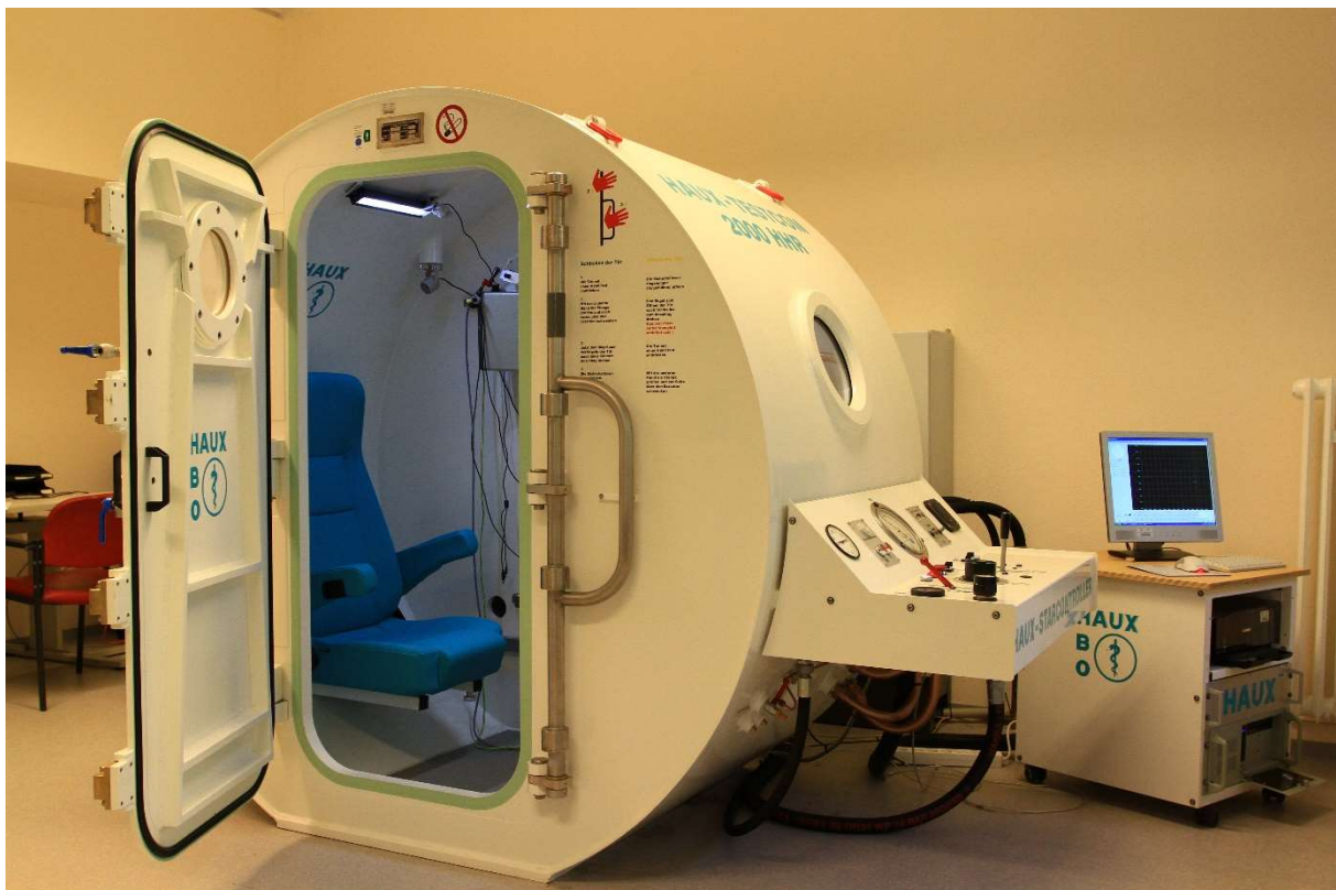
Abbildung 5 Druckkammer der Fa. Haux Life Support und Tubenfunktionsmessplatz an der Klinik für Hals-Nasen- und Ohrenheilkunde an der Uniklinik Köln 84 .
