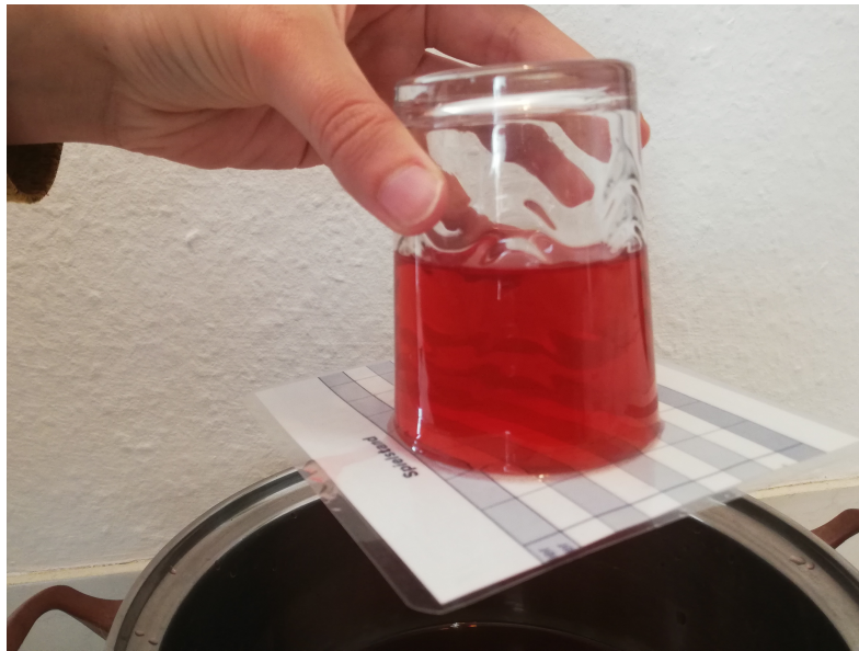
Abbildung A.14: Die Karte verschließt das Glas, sodass das Wasser nicht ausfließen kann, obwohl das Glas kopfüber gehalten wird.
