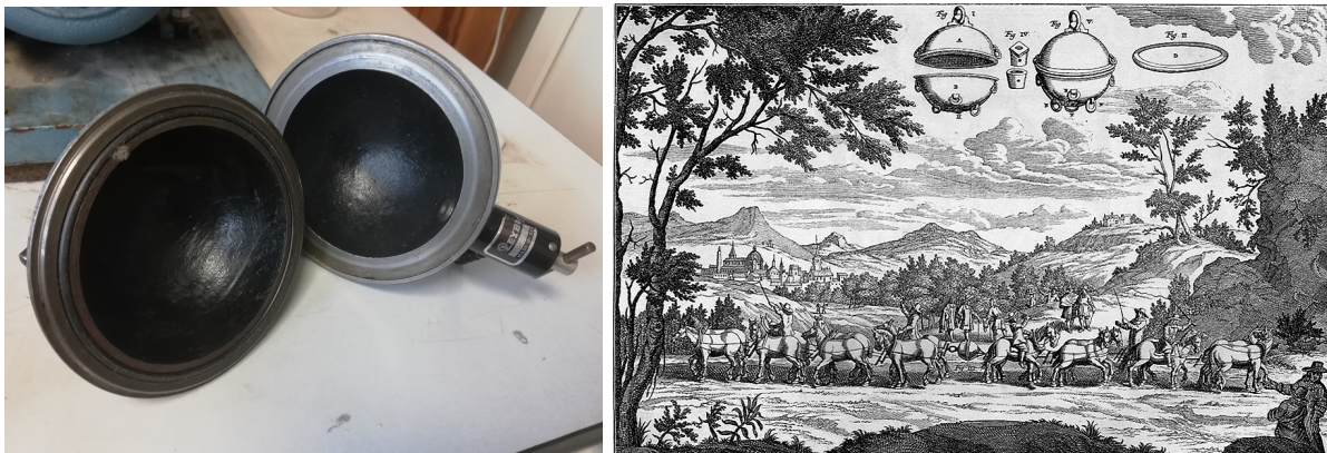
Abbildung 4.6: Die Magdeburger Halbkugeln als Foto (links) und als Zeichnung des historischen Experimentes (rechts) [42].
