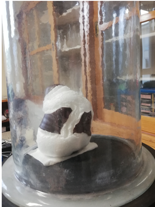
Abbildung A.19: Ein Schokokuss vergrößert sein Volumen stark, wenn er sich unter einer Vakuumlöcke befindet.
