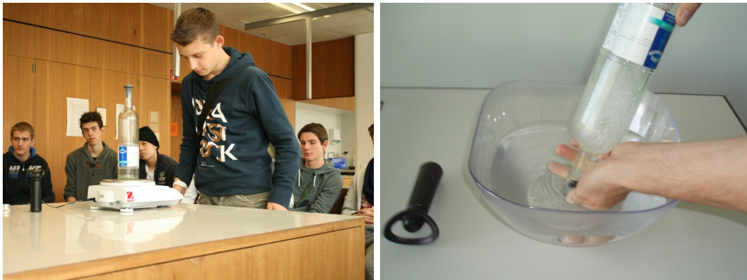
Abbildung A.8: Die Dichte der Luft wird mit Hilfe einer Glasflasche und einer Vakuumpumpe bestimmt.
