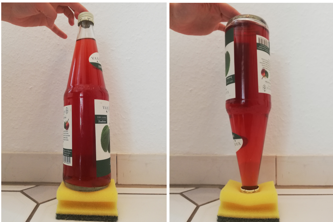
Abbildung A.1: Mit einer Glasflasche und einem Spülschwamm wird der Zusammenhang zwischen Kraft, Fläche und Druck demonstriert.
