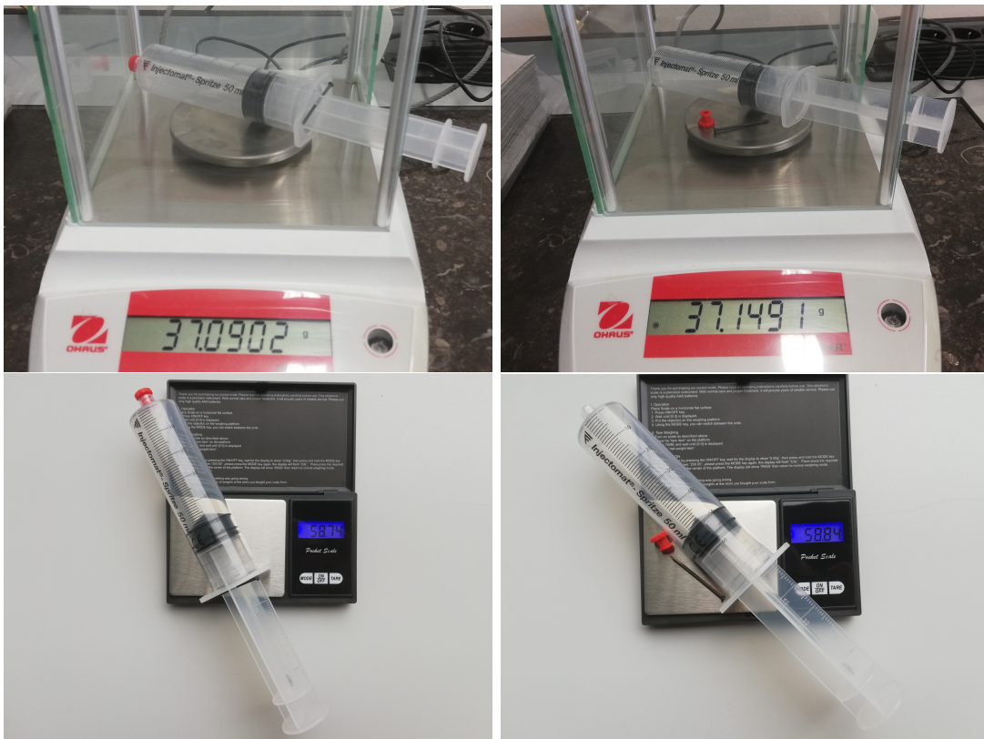
Abbildung A.9: Die Dichte der Luft wird mit Hilfe einer großen Spritze bestimmt.
