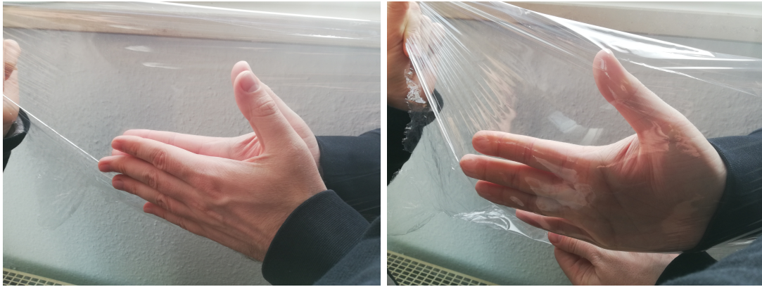
Abbildung A.18: Wenn auf beiden Seiten der Folie die gleiche Kraft aufbewendet wird, verändert sie sich nicht. Erst durch eine einseitige Kraft wird die Folie ausgebeult.
