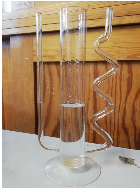
Abbildung A.6: Miteinander verbundene Gefäße unterschiedlicher Durchmesser und Form.
