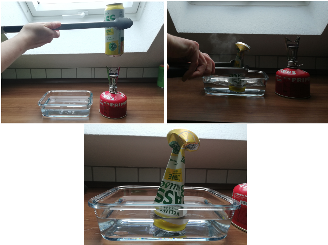
Abbildung A.21: Wasser wird in der Dose erhitzt, bis sie vollständig mit Wasserdampf gefüllt ist. Anschließend wird sie kopfüber in kaltes Wasser getaucht.
