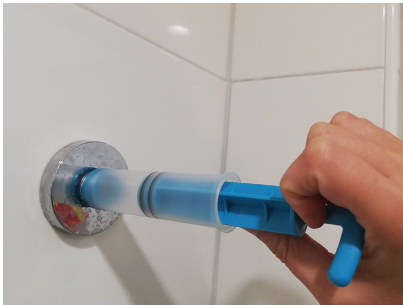
Abbildung A.12: Saugnapf, der mit einer Handvakuumpumpe vakuumiert wird, um besonders gut zu halten.
