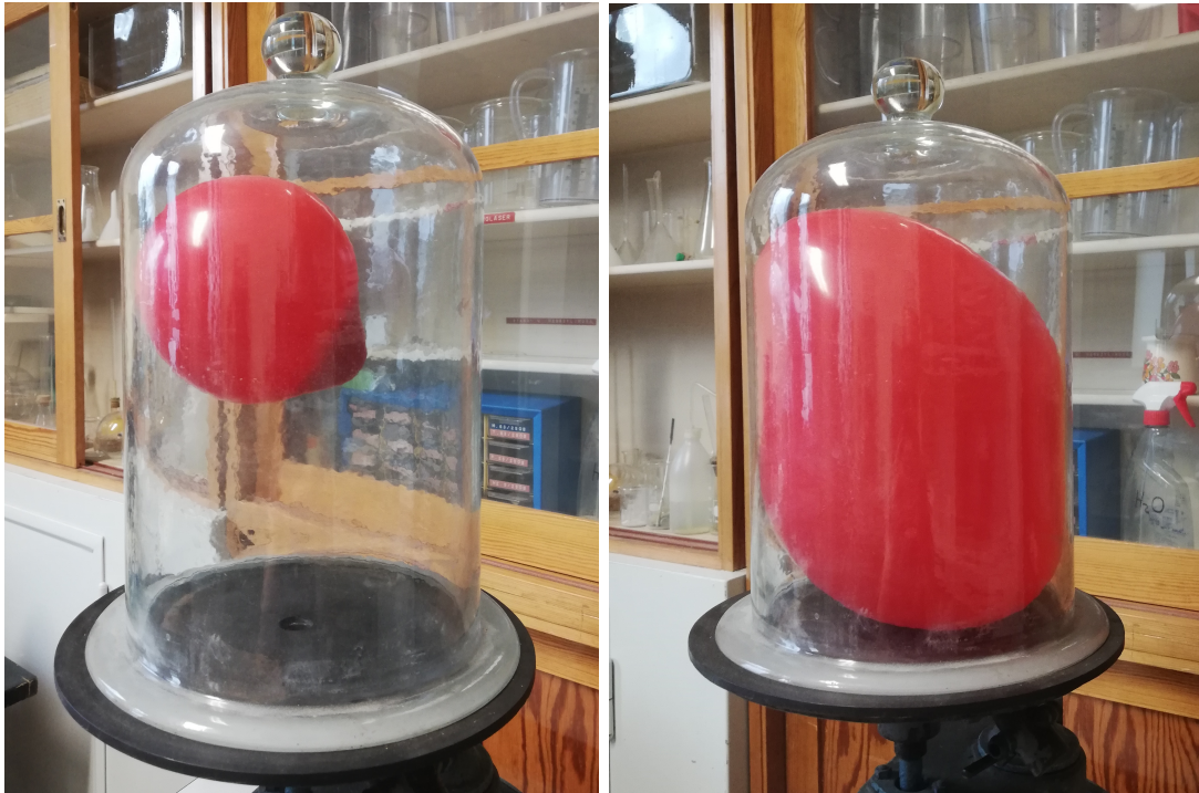
Abbildung A.2: Der Luftballon dehnt sich beim Vakuumieren gleichermaßen in alle Richtungen aus, bis er die Wand der Glasglocke berührt.
