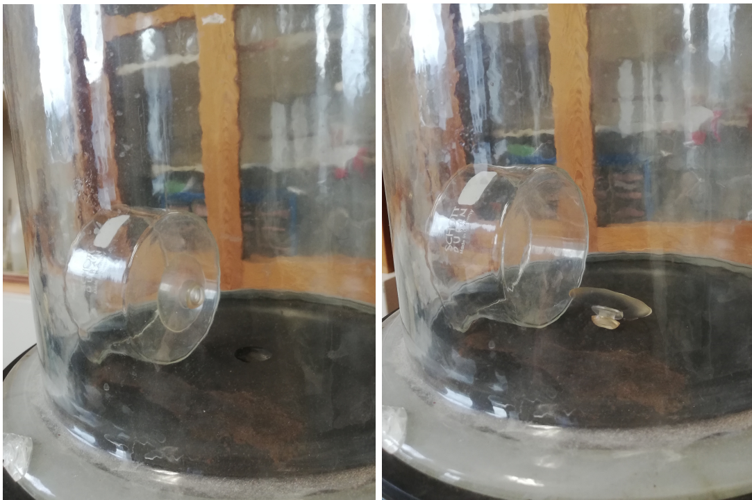
Abbildung A.11: Beim evakuieren löst sich der Saugnapf vom Untergrund.
