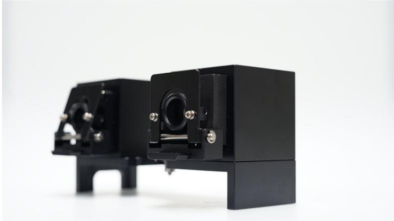
**Abbildung 19** Kugelmodul mit 50 mm Transmissions-/Reflexionskugel und eingespannter 3-D-gedruckter Halterung (rechte Transmissionsprobennahmestelle).
