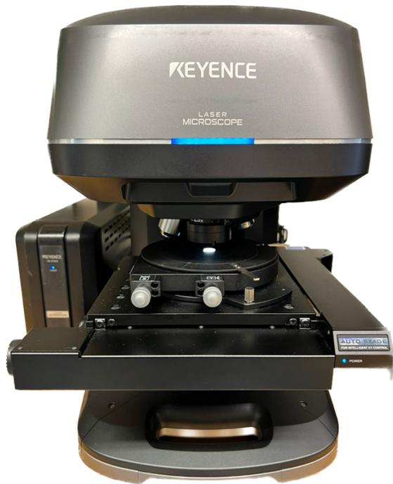
**Abbildung 20** 3-D-Laser-Scanning-Mikroskop (VK-X3100, KEYENCE Corporation, Osaka, Japan) mit einem Prüfkörper auf der Scanplattform.
