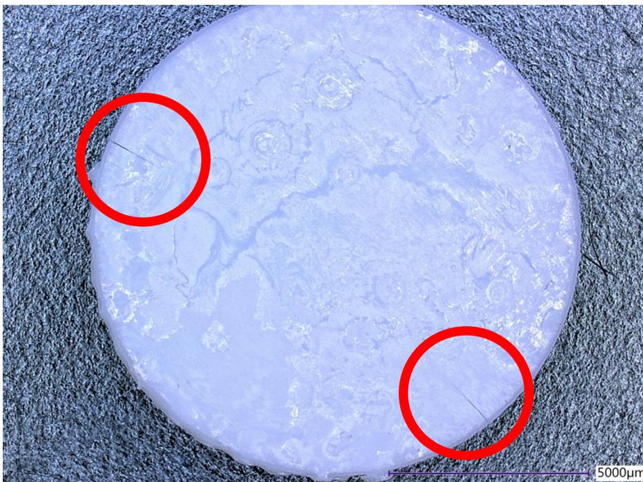
**Abbildung 31** Übersichtsaufnahme eines Prüfkörpers der PPC-Gruppe C nach dem Sintern mit doppelter, vom Rand ausgehender Rissformation (innerhalb der roten Markierungen). Zusätzlich sind auf der Oberfläche schimmernde Bereiche erkennbar.
