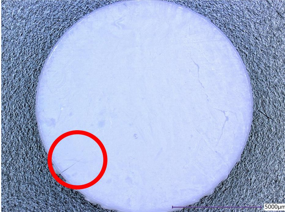
**Abbildung 30** Übersichtsaufnahme eines Prüfkörpers der PPC-Gruppe D nach dem Sintern mit einzelner, vom Rand ausgehender Rissformation (innerhalb der roten Markierung).
