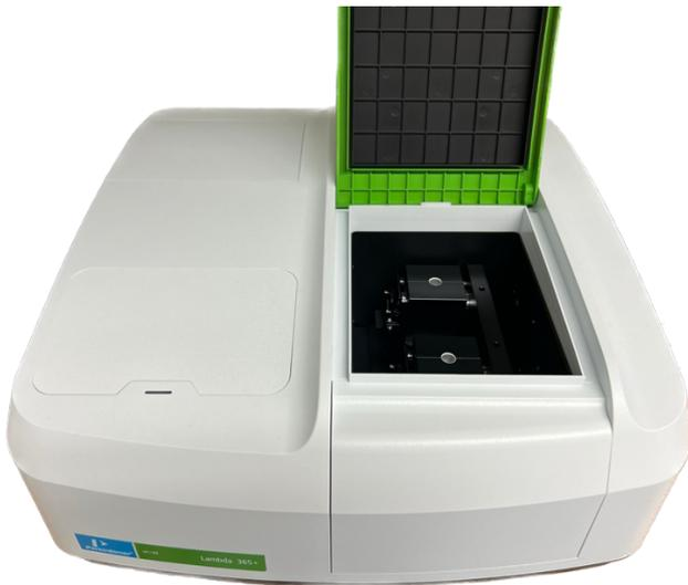
**Abbildung 18** Zwei-Strahl-UV-Vis-Spektralphotometer (Lambda 365+, PerkinElmer, Waltham, MA, USA) mit eingesetztem Kugelmodul mit 50 mm Transmissions-/Reflexionskugel.
