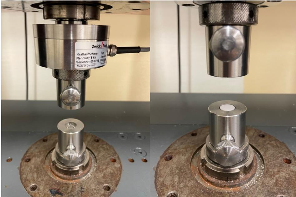
**Abbildung 21** Messingblock der Universalprüfeinrichtung (Z005, ZwickRoell, Ulm, Deutschland) mit drei Kugeln ohne Prüfkörper (links) und mit Prüfkörper (rechts).
