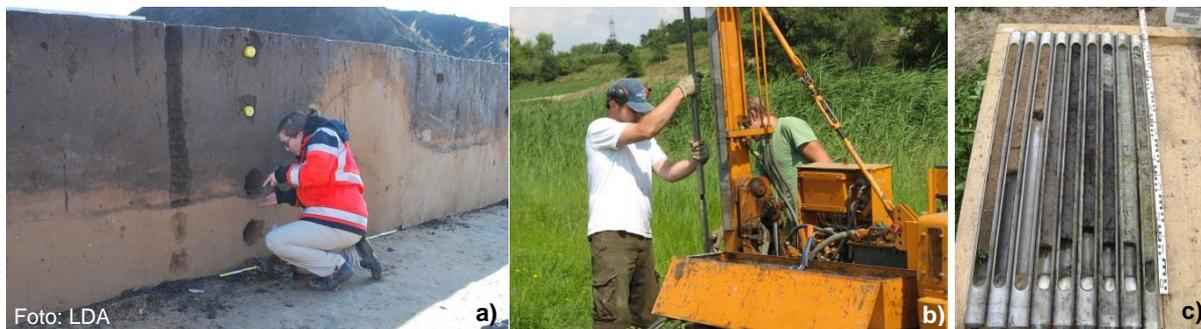
Abb. 3-2: a) Probennahme am Profil, b) Rammkernsondierungen mit der Bohrraupe, c) Probennahme aus der Bohrsonde
