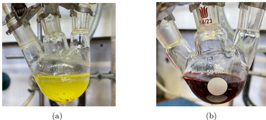
**Abbildung 4.59:** Aufnahmen der erhaltenen Lösungen nach dem Einleiten von Acetylgas in eine Elektrizitäts-Lösung mit Europium (a) und Ytterbium (b).
