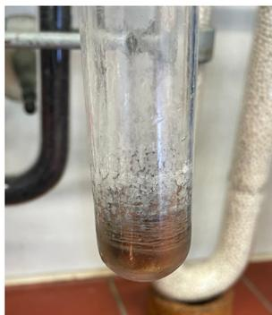
**Abbildung 4.42:** Aufnahme des Versuchs zur Darstellung von  $\text{BaC}_2$  durch die Umsetzung von  $\text{Ba}(\text{C}_2\text{H})_2$  mit  $\text{Ba}$  nach der Durchmischung in flüssigem Ammoniak und vor Beginn des Heizprozesses.
