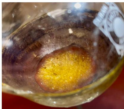
**Abbildung 4.61:** Erhaltene Kristalle von  $\text{Eu}(\text{C}_2\text{H})_2$  im Synthesekolben nach langsamem Abdampfen des Ammoniaks.
