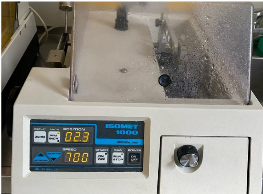
Abbildung 3: Schneidemaschine Isomet 1000 mit Einstellung bei 700 U/min und einer Schnittdicke von 2,3 mm
