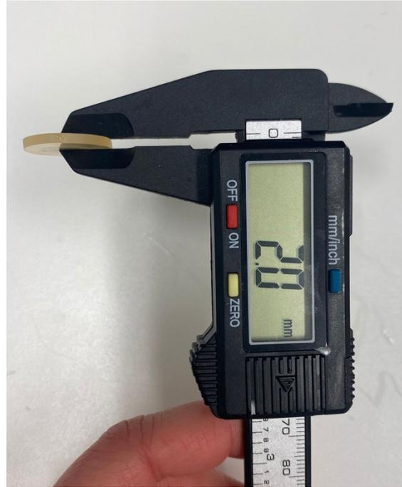
Abbildung 4: Herstellung der geschnittenen Zahnproben mittels diamantierter Trennscheibe und Überprüfung der Schichtstärker von 2 mm pro Zahnscheibe
