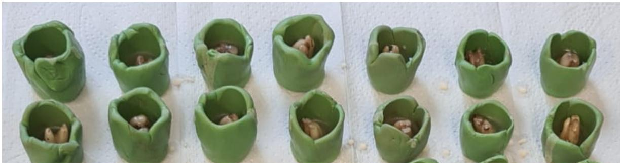
Abbildung 2: Silikoneinbettformen mit eingesetzten Zähnen, die in der Scandiquick Einbettmasse aushärten
