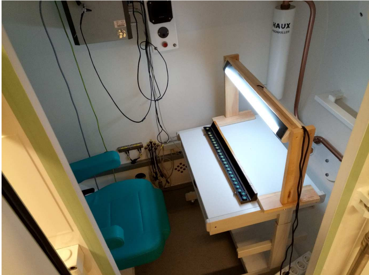
Abbildung 8: Testaufbau Teil 2; Tageslichtlampe mit einer D65 Leuchtstoffröhre, Kollimatorfolie und Dimmfolie; FM Hue-100 Farbkäppchen
