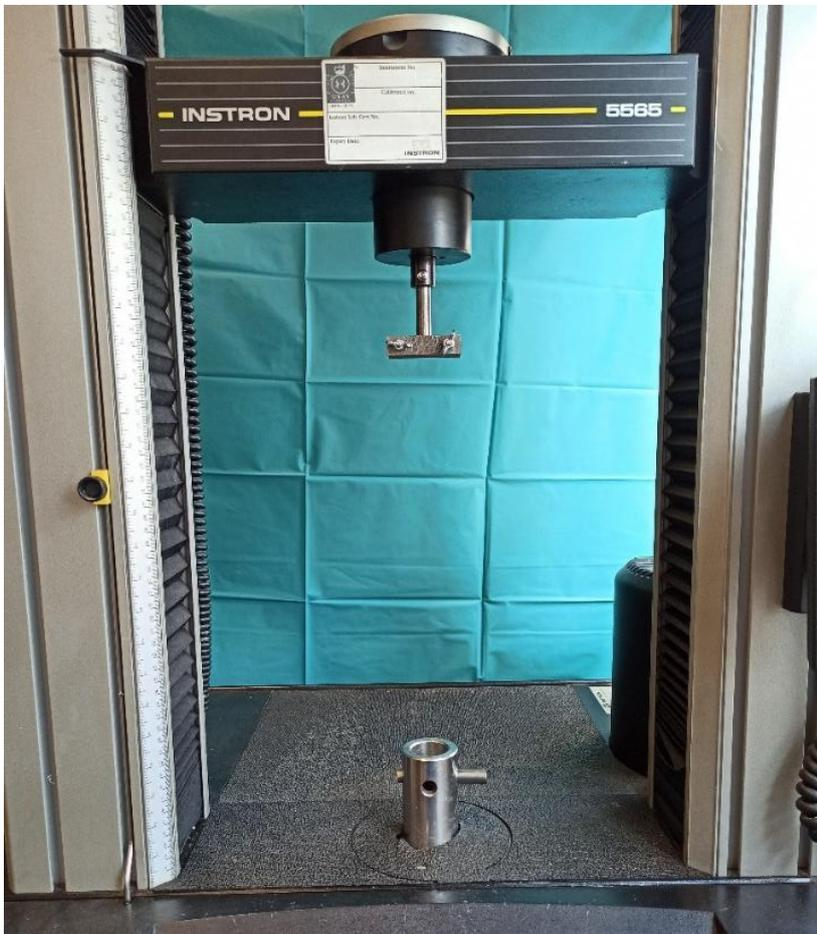
Abbildung 9 Instron 5565®- Zugprüfmaschine<sup>1</sup>
