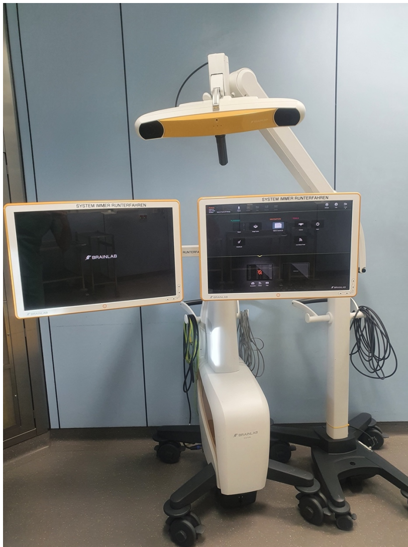
Abbildung 9: BrainLAB Curve mit der Navigationseinheit mit 2 Monitoren links im Bild und Schwenk-Arm mit 2 Infrarotkameras und Steuerhandgriff hinten rechts im Bild.
