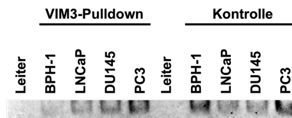
Abbildung 16: Visualisierung des PCR-Produkts für die Promoterregion der pri-MicroRNA-371a-3p. Für den VIM3-Pulldown wurde der VIM3 Antikörper zunächst an Agarose-Beads gekoppelt (1:10) und anschließend mit den Proben aller Zelllinien inkubiert. Danach folgte die DNA-Isolation dieser Proben (VIM3-Pulldown) sowie der Proben ohne vorherigen VIM3-Pulldown (Kontrolle). Im Anschluss an die DNA-Extraktion wurde eine PCR-Analyse mit einem spezifischen Primer für die Promoterregion der pri-MicroRNA-371a-3p durchgeführt. Zur Visualisierung des PCR-Produkts wurde ein zwölfprozentiges Polyacrylamid-Gel verwendet, welches für 40 Minuten bei 100 V lief. 1x TBE diente als Laufpuffer und ein 50 bp vorgefärbter DNA-Marker diente als Leiter. Fluoreszenzsignale wurden mit dem Intas Chemostar Reader für grüne (488 nm) und blaue (625 nm) Kanäle detektiert.
