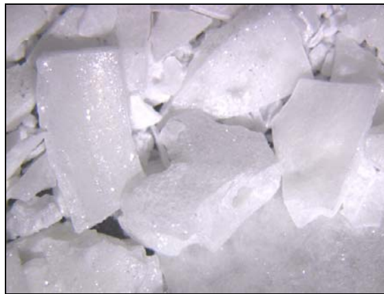
Abb. 54: Feinkristallines Material, vermutlich von DyB_3O_6 aus dem System Na_2O-Dy_2O_3-B_2O_3 (Bildgröße 10,0 x 7,5 mm)
