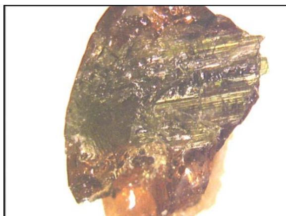
Abb. 44: Dunkel-grüne, flache Kristalle von CeB_3O_6 aus dem System SrO-Ce 2 O 3 -B 2 O 3 in braunem Glas (Bildgröße 10,0 x 7,5 mm)
