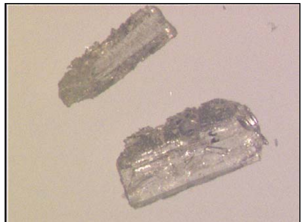
Abb. 49: Kristalle von EuB 3 O 6 aus dem System SrO-Eu 2 O 3 -B 2 O 3 (Bildgröße 1,9 x 1,5 mm)
