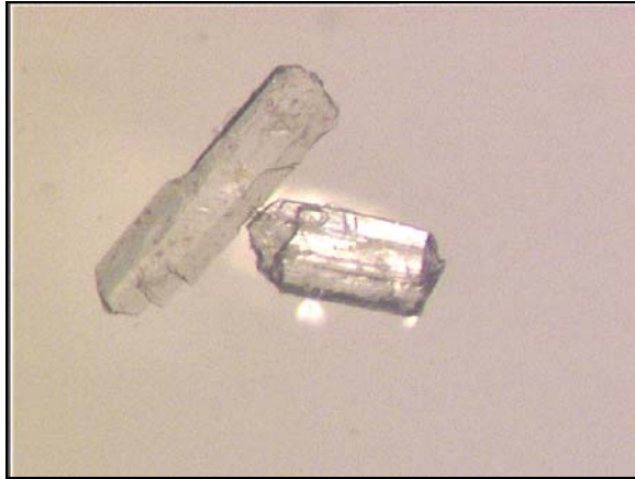
Abb. 50: Kristalle von GdB 3 O 6 aus dem System SrO-Gd 2 O 3 -B 2 O 3 (Bildgröße 1,9 x 1,5 mm)
