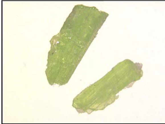
Abb. 45: Kristalle von PrB 3 O 6 aus dem System SrO-Pr 2 O 3 -B 2 O 3 (Bildgröße 6,0 x 4,6 mm)
