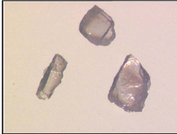
Abb. 42: Kristalle von \text{NdB}_3\text{O}_6 aus dem System \text{Nd}_2\text{O}_3\text{-B}_2\text{O}_3 (Bildgröße 2,5 x 1,8 mm)
