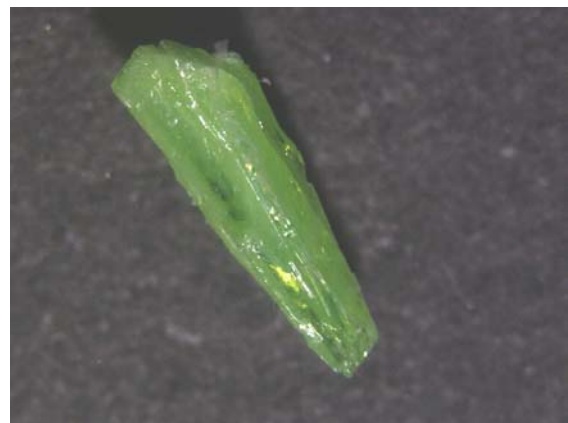
Abb. 41: Kristall von \text{PrB}_3\text{O}_6 aus dem System \text{Pr}_2\text{O}_3\text{-B}_2\text{O}_3 (Bildgröße 6,0 x 4,6 mm)
