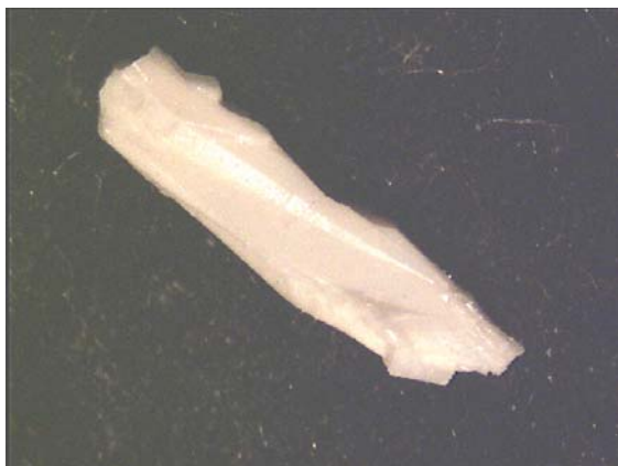
Abb. 40: Kristalle von \text{LaB}_3\text{O}_6 aus dem System \text{La}_2\text{O}_3\text{-B}_2\text{O}_3 (Bildgröße 5,0 x 3,6 mm)
